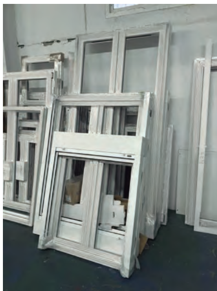
Figura 65. Ventana con cajón de persiana almacenada en taller
