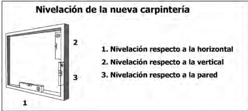
Figura 14. Nivelación de la nueva carpintería
