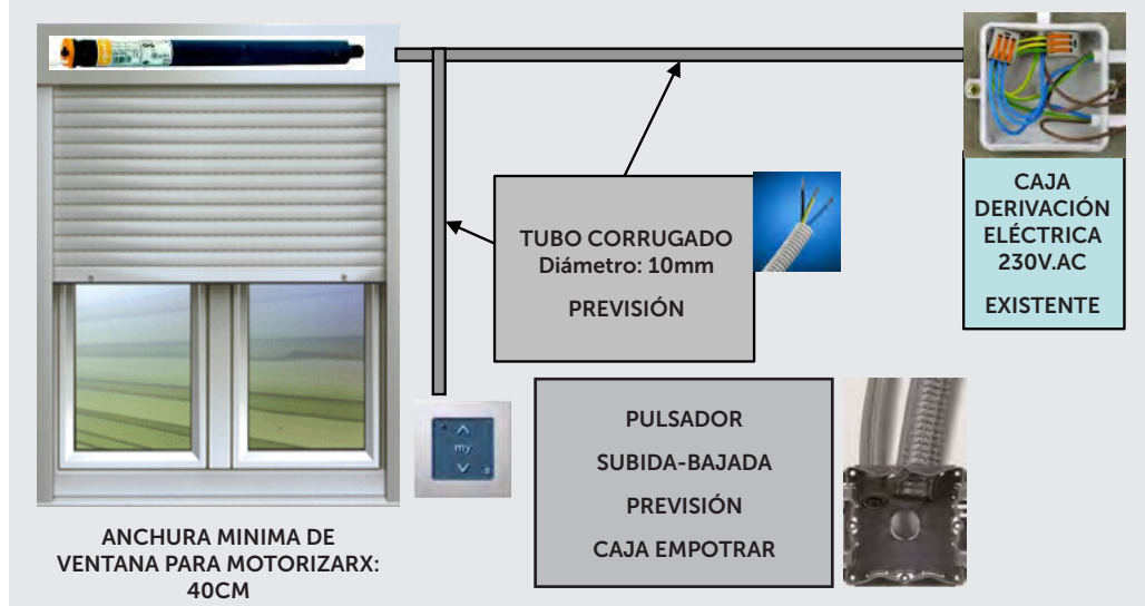
Figura 82. Esquema con mando a distancia. Preinstalación necesaria con sistema IO/ RTS RADIO
